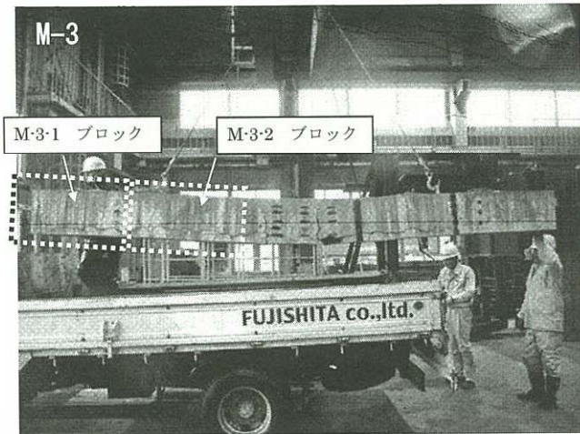
図-4 梁供試体の外観状況（载荷試験後）
