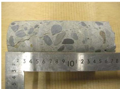
図-11 採取コアのひび割れ状況
