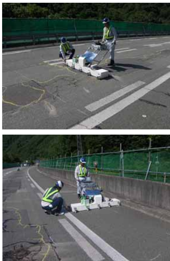
図-15 多配列レーダ法の試行
