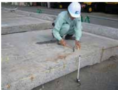
図-12 打音法で検出した浮きと水平ひび割れから推定した浮き
