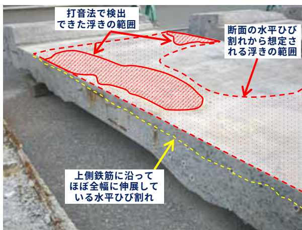
図-12 打音法で検出した浮きと水平ひび割れから推定した浮き
