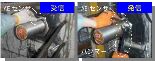
写真 2.1 衝撃弾性波法測定状況
