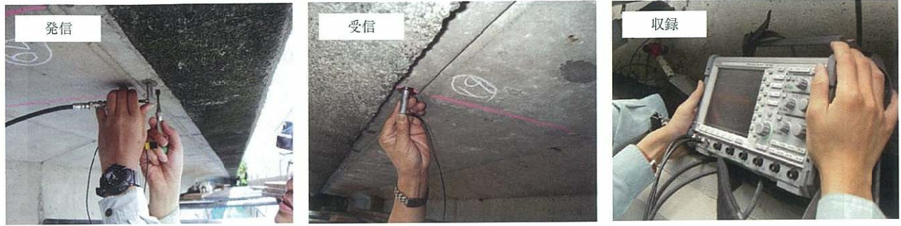
写真-8 衝撃弾性波法の測定状況
