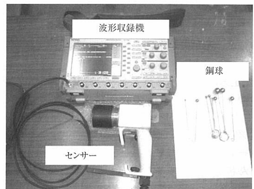
図-5 インパクトエコー法の測定装置
